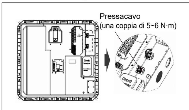
1-2. Oppure, sigillare il pressacavo con sigillante dopo la serratura del pressacavo.
